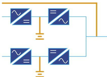
Ogni modulo PU è dotato di un banco batterie dedicato. Ciò garantisce un'elevata flessibilità nella gestione delle batterie e una scalabilità della potenza.
