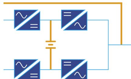
All'UPS è collegato un unico banco di batterie. Questo semplifica l'installazione e l'assistenza e riduce il tempo medio di riparazione (MTTR) e l'ingombro.
